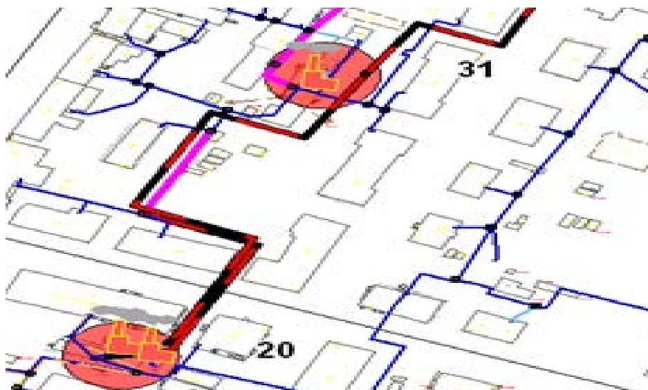
Рисунок 5.2.19 Схема прокладки трубопровода между котельными №31 и №20
