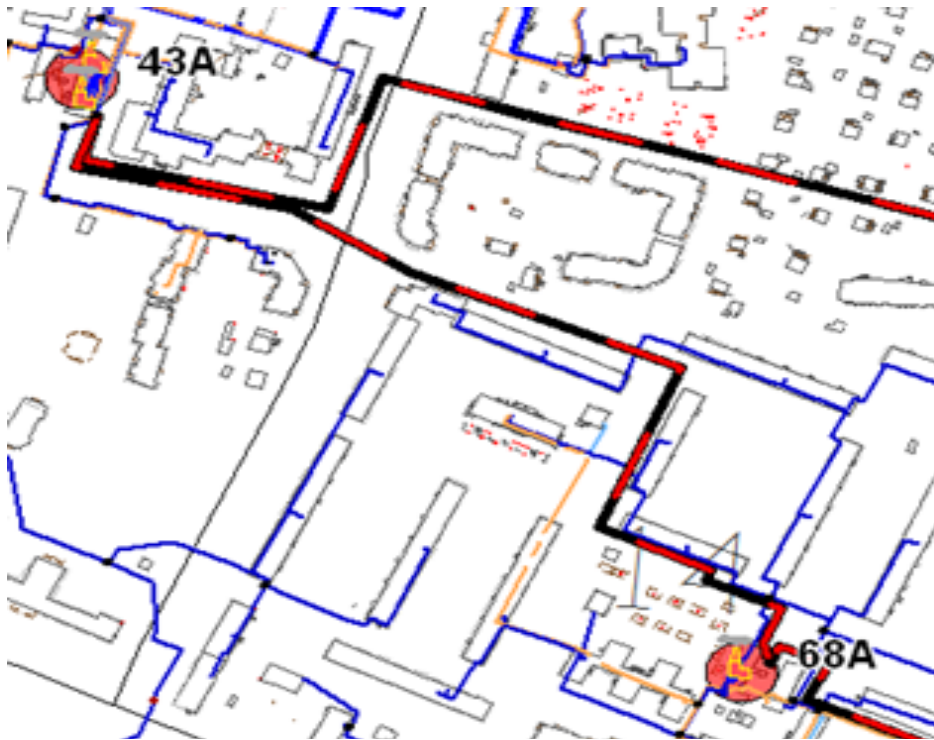
Рисунок 5.2.7 Схема прокладки трубопровода от котельной №43 до котельной №68
