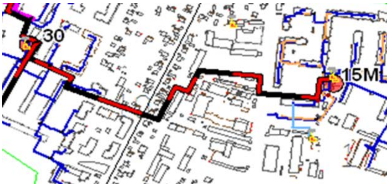
Рисунок 5.2.6 Схема прокладки трубопровода от котельной №15 до котельной №30
