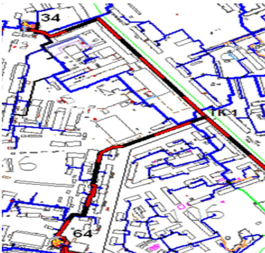
Рисунок 5.2.29 Схема прокладки трубопровода между котельными №34 и №64
