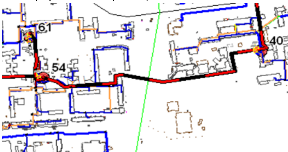
Рисунок 5.2.42 Схема прокладки трубопровода между котельными №40 и №54
