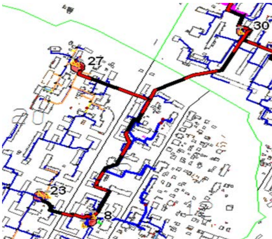
Рисунок 5.2.3 Схема прокладки трубопровода от котельной №30 до котельной №8
