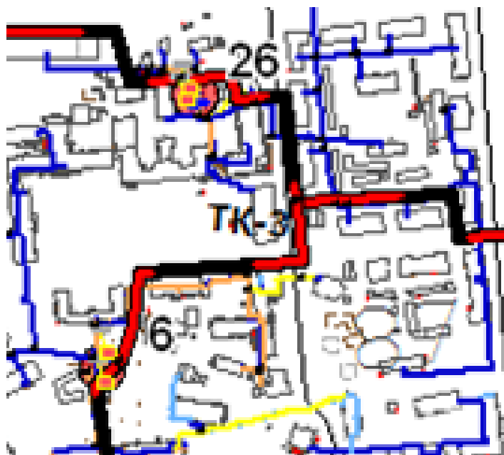
Рисунок 5.2.25 Схема прокладки трубопровода между котельными №6 и №26
