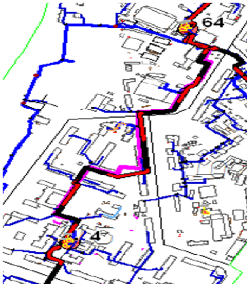
Рисунок 5.2.22 Схема прокладки трубопровода между котельными №4 и №64
